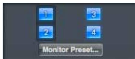
Estos botones seleccionan cual de las salidas de línea de Scarlett 6i6 se verán afectadas por los otros controles de la sección de monitorización GUI y también por los controles de monitorización del panel frontal. Dependiendo de su configuración de monitorización, usted puede monitorizar sin altavoces, sólo con un altavoz o con hasta 4 altavoces de forma simultánea.
