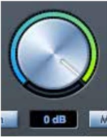
Ajuste el nivel de salida de todas las salidas seleccionados con este control utilizando el mouse. La pantalla numérica muestra el nivel actual de la salida de monitorización.
